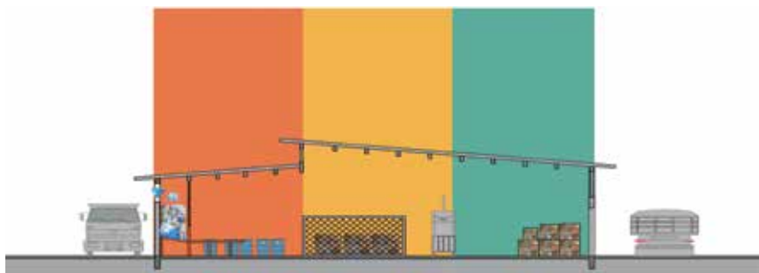
Figura 3 Galpão sem desnível interno
