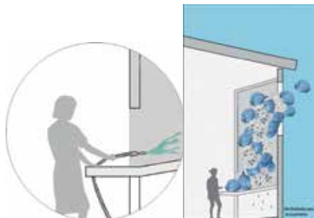
Figura 13 Limpeza da gaiola com base e com desnível
